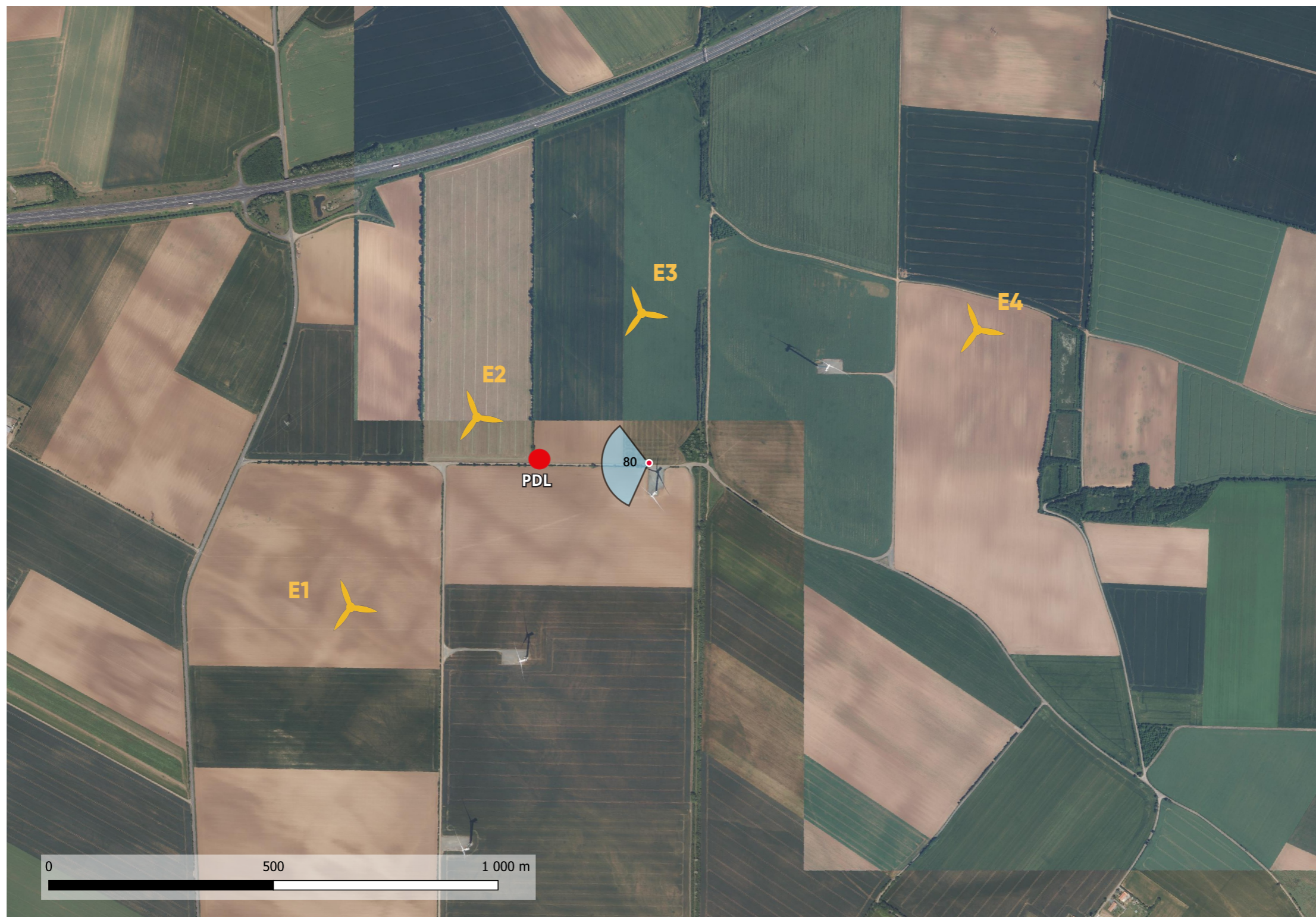
Figure 127 : Localisation du poste de livraison
